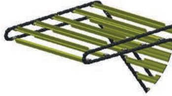
Üst Konveyör Asansör Zincir Ve Balet Upper Conveyor Lift Chain And Palette
